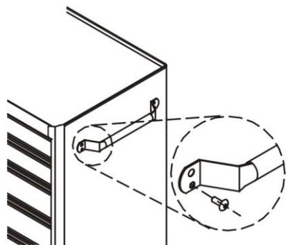
Fixez la poignée sur le côté de l'armoire à l'aide des boulons hexagonaux M6. Serrez les boulons au moyen de la clé.
